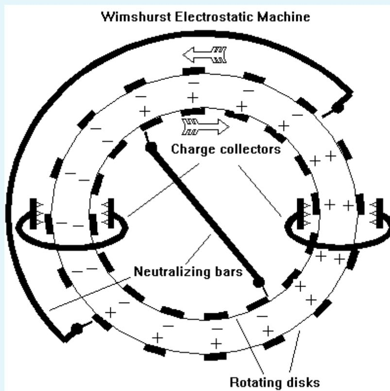
**Fig. 2. Esquema de funcionamiento de la maquina Wimshurst.**
